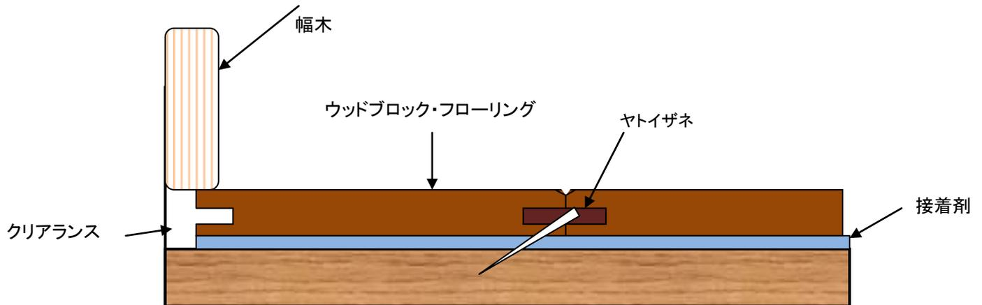
※必ず、釘と接着剤を併用して施工してください。
